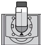
7. Retire el tubo del colorímetro. Añada una DPD #1 IG Tablet [6903A]. Tape el tubo y agite durante 10 segundos. Dele la vuelta lentamente 5 veces. La solución se volverá de color rosa si hay bromo.
