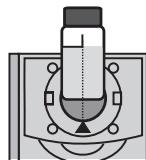
6. Enlevez l'éprouvette du colorimètre. Ajoutez une DPD #1 IG Tablet [6903A]. Fermez l'éprouvette avec son bouchon et agitez-la pendant 10 secondes. Renversez-la lentement 5 fois. La solution devient rose si elle contient du chlore libre.
