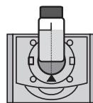
7. Enlevez l'éprouvette du colorimètre. Ajoutez une DPD #1 IG Tablet [6903A]. Fermez l'éprouvette avec son bouchon et agitez-la pendant 10 secondes. Renversez-la lentement 5 fois. La solution devient rose si elle contient du brome.
