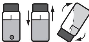
8. Insérez immédiatement l'éprouvette dans la chambre. Fermez le couvercle. Sélectionnez **Scanner échantillon**. Enregistrez le résultat en tant que chlore libre. 025 Chlore T DPD
